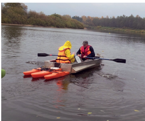
Измерение расхода воды с помощью профилографа (09 октября 2013 г.) на р. Луге (в 0,05 км выше устья руч. Горского)
