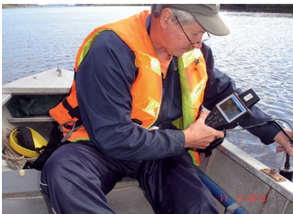
Определение физических и химических параметров воды р. Луги с помощью анализатора «Хориба» (11.09.2013 г.)
