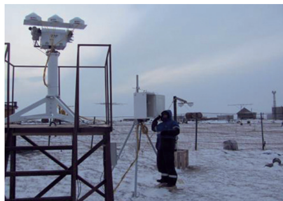
Настройка автоматизированного актинометрического комплекса (ААК) на ОГМС Диксон
